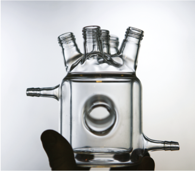
199 Exemple de formes complexes obtenues par la technique du verre soufflé.
