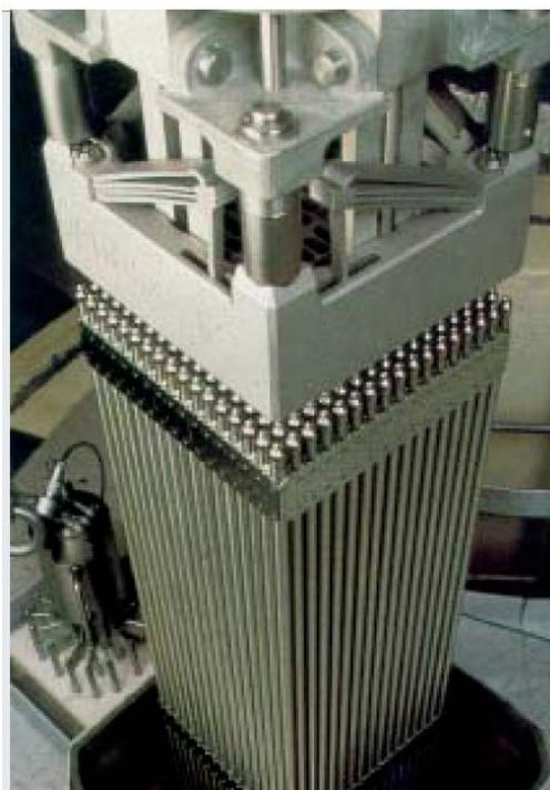
Figure 4. Description d'un assemblage combustible type REP, d'après [28]
