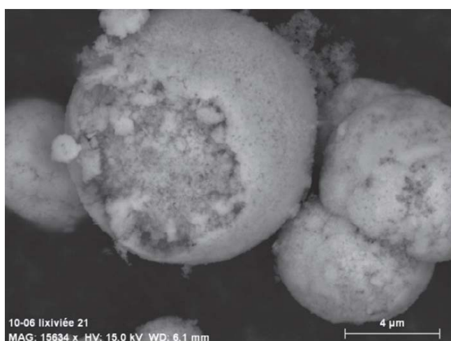
Figure 53. Clichés MEB d'une poudre de barytocalcite lixiviée dans l'eau à 1, 3, et 5h.
