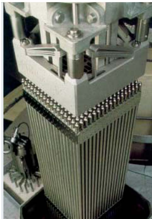
Figure 4. Description d'un assemblage combustible type REP, d'après [28]
