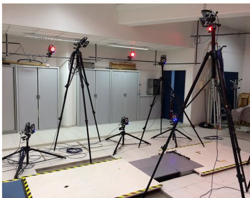
**Figure I.2** – Système de caméras à marqueurs passifs
