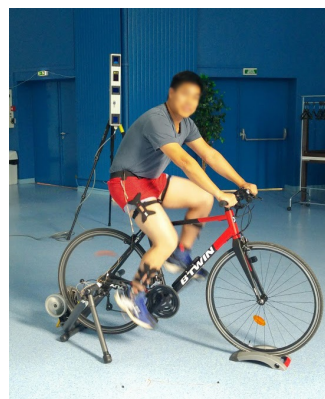
Figure I.3 – Marqueurs actifs et cellule photosensible
