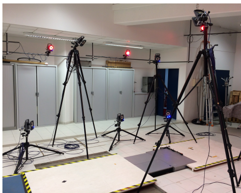
Figure I.2 – Système de caméras à marqueurs passifs
