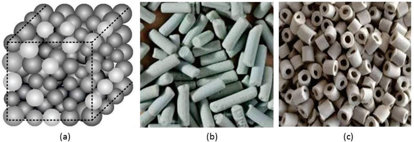
Figure I. 1 : Sphères (a), extrudés (b) et anneaux Raschig (c) pouvant servir de supports catalytiques
