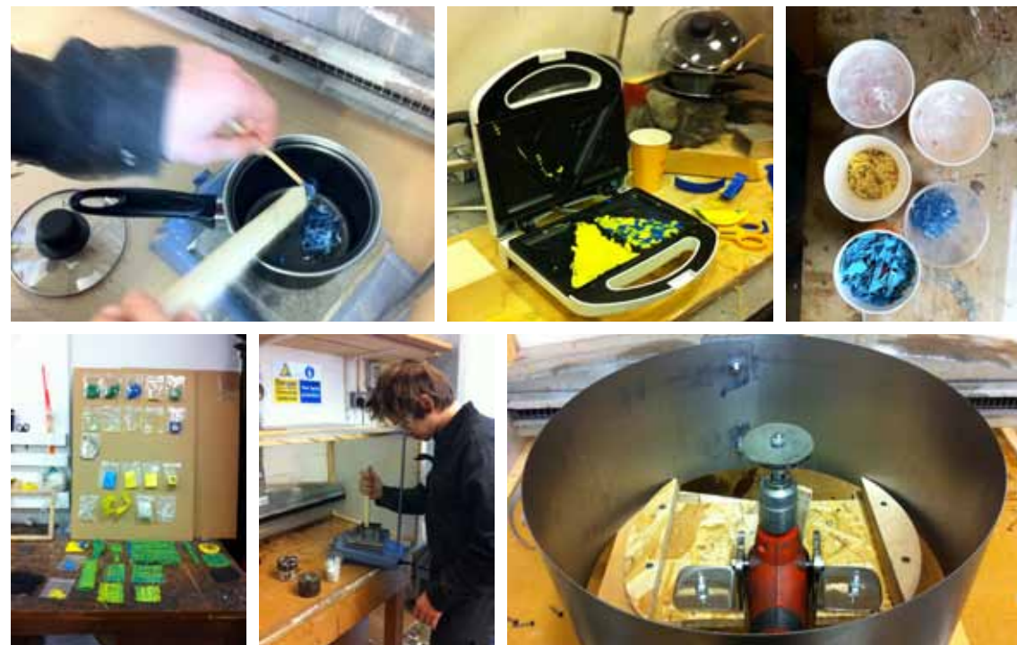
Fig 16. Premier test de fonte de déchets plastiques dans une casserole, RCA, 2011.
