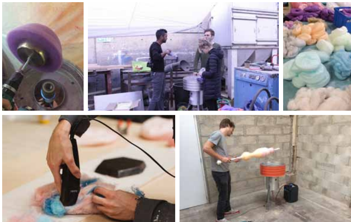
Fig 34. Fabrication de matière Polyfloss par enroulement des fibres sur un bol monté sur une perceuse. Plus la vitesse de rotation est importante, plus les fibres sont fines, mais risquent de se désolidariser.
