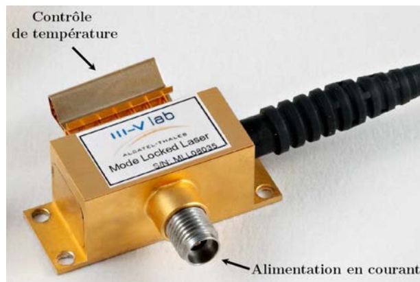
FIGURE 3.3: Photographie du module de la source utilisée (fabriqué au III-V LAB) Le connecteur électrique type-V sert à polariser la diode avec un courant continu comme il sert à la modulation du courant.
