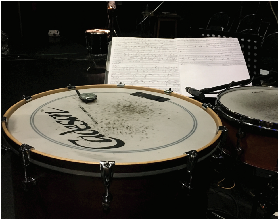
Fig. 68. Positionnement des transducteurs sur le tom grave et en dessous de la caisse claire.
