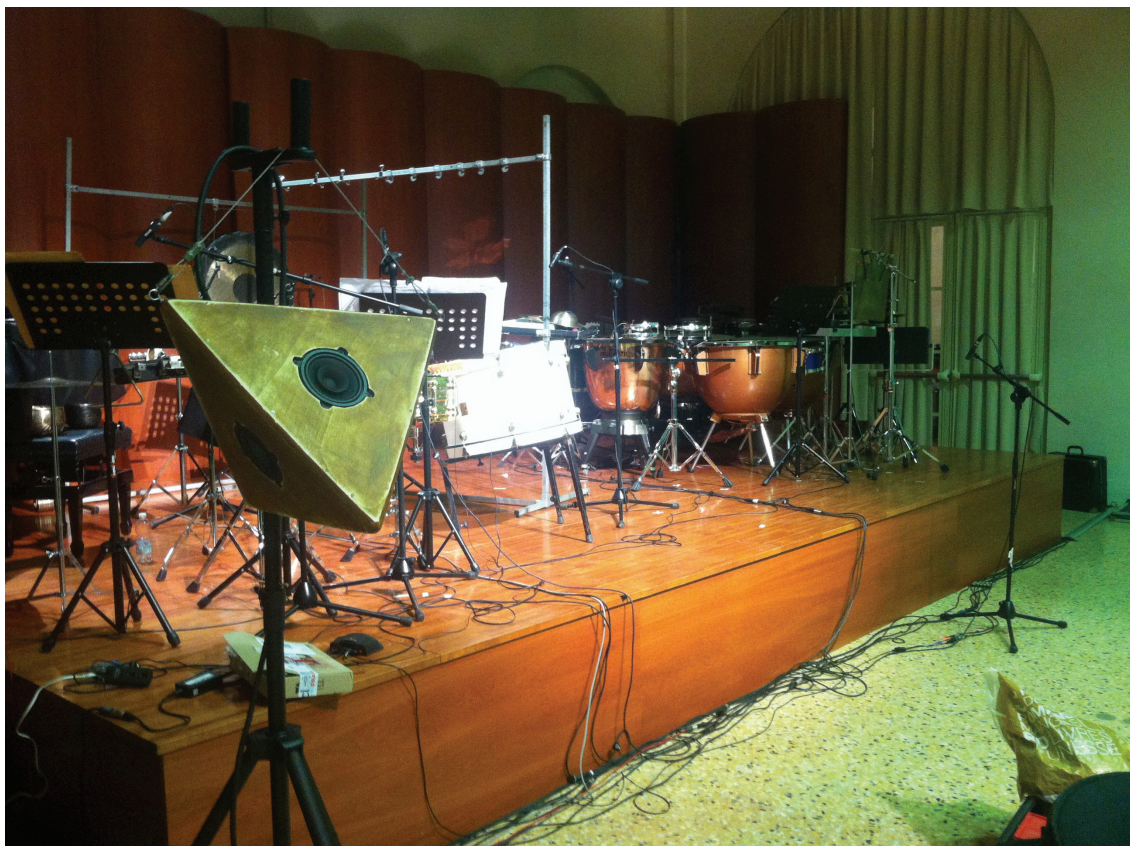
Fig. 69. Photo du haut-parleur S.T.ONE (Spherical Tetrahedral ONE) développé par Giuseppe Silvi. Nous avons capturé le son instrumental avec 2 microphones statiques cardioïdes et ensuite nous les avons routé directement vers le S.T.ONE sans délais ni filtrages ni réverbération.
