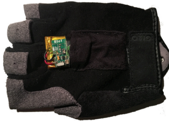
Fig. 21. Exemple de gant intégrant un capteur RiOT 9 DOF.
