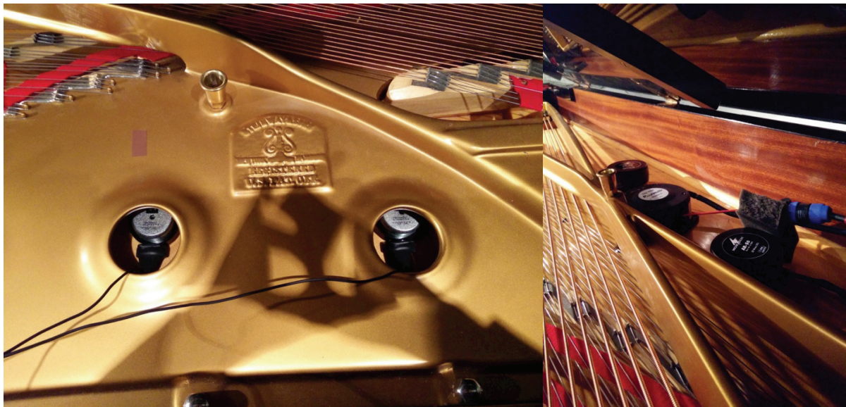
Fig. 66. Positionnement des transducteurs à l'intérieur du piano (photos de Thomas Goepfer).
