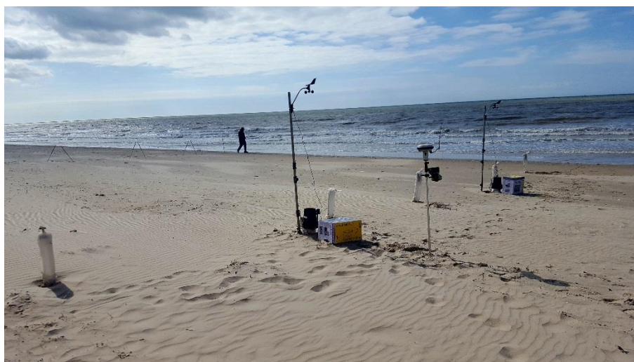
Figure VI-32 : photographie illustrant la mise en place des pièges sur le haut de plage lors de l'expérimentation du 30 mai 2017 au site de Dunkerque.
