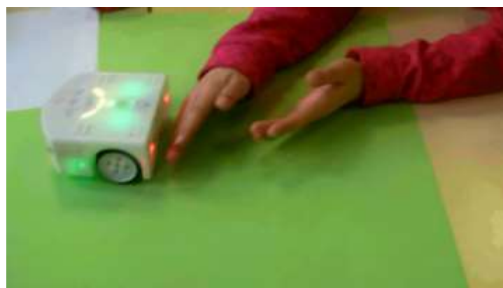
FIGURE 16 - LES CAPTEURS ARRIERES DETECTENT LES MAINS
