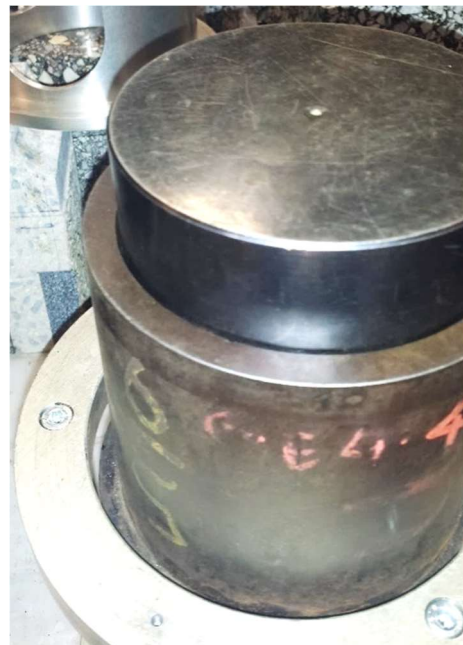
Figure 118 - Etape 4 : Mise en place du casque sur le matériau.
