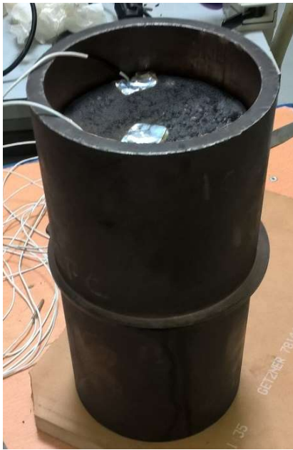
Figure 126 - Mise en place des sondes de température.
