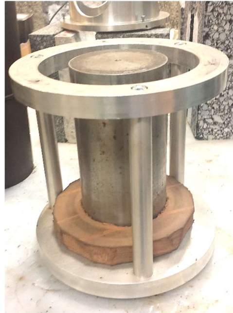
Figure 116 - Etape 2 : Mise en place de l'élastomère autour de la cale.
