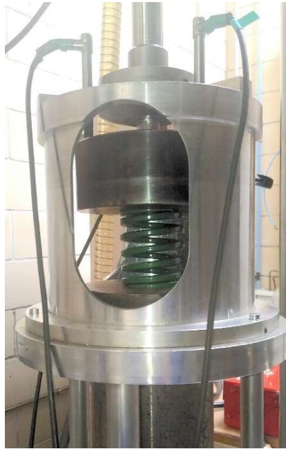
Figure 125 – Mesure du déphasage induit par toute la chaîne de mesure.
