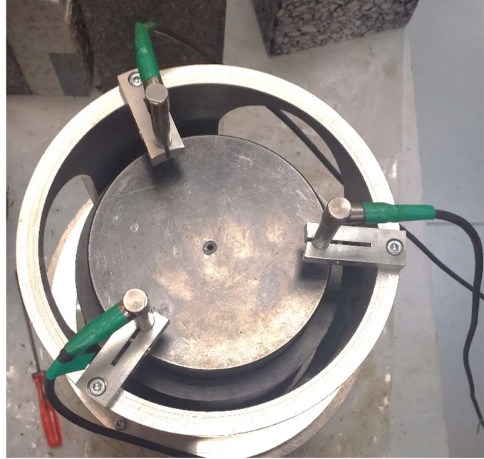
Figure 120 - Etape 6 – Mise en place et réglage des capteurs de déplacement en position initiale.
