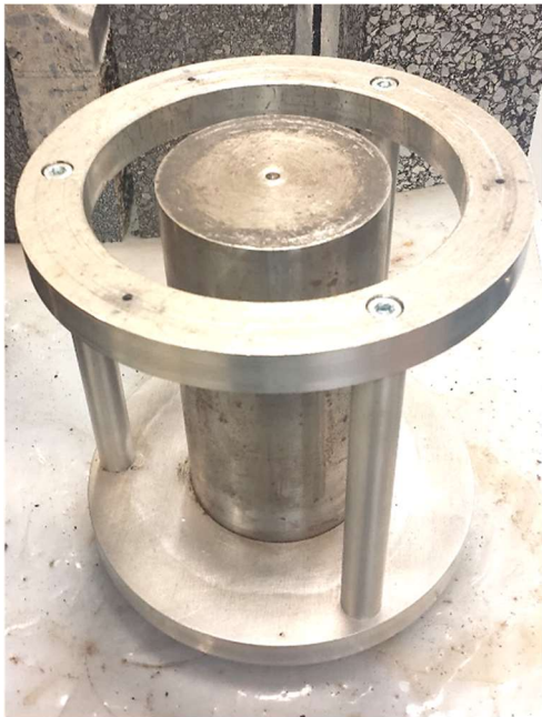
Figure 115 - Etape 1 : Mise en place du support inférieur sur le bâti de la presse.
