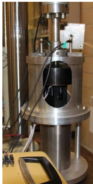
Figure 132 - Mesure en compression simple sur Delrin®.
