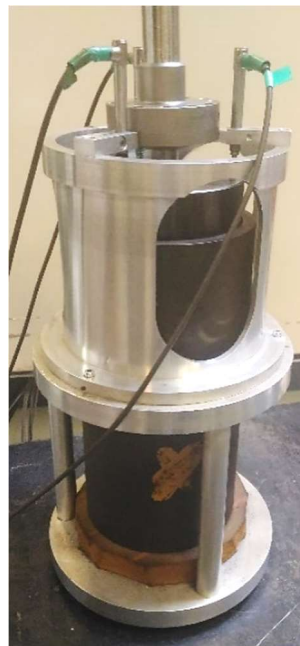
Figure 121 - Etape 7 - Démarrage de l'essai avec application de l'effort cyclique souhaité.
