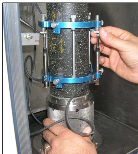
Figure 21 - Dispositif de mesure de l'augmentation de hauteur de l'échantillon.
