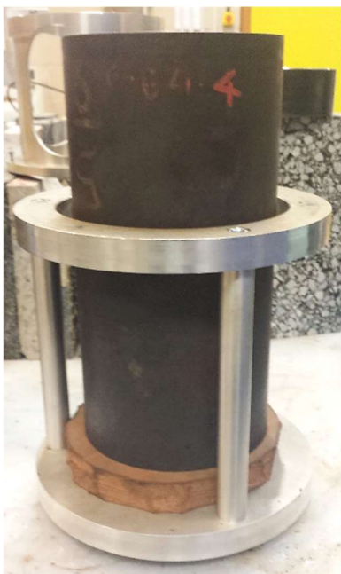
Figure 117 - Etape 3 : Mise en place de l'éprouvette et du cylindre sur le support inférieur.
