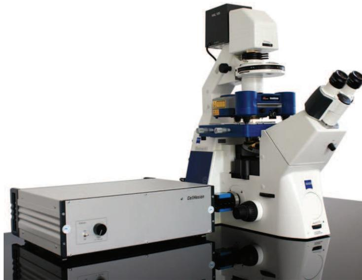
**Figure 26 : Tête AFM de type Nano-Wizard 1 de la marque JPK Instruments montée sur un microscope inversé de type AxioObserver Z1 de la marque Zeiss**
