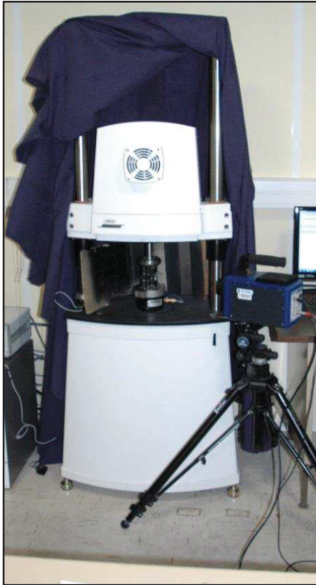
Figure II.2.1 : a) Dispositif expérimental de l'étude, b) zone du montage d'éprouvette et caméra infra-rouge Flir SC7000
