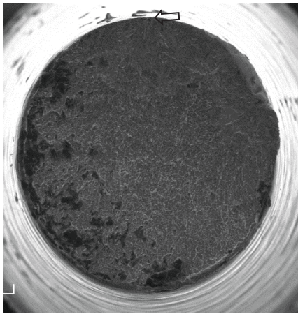
Figure II.5.5 : Micrographies obtenues à partir de la microscopie électronique à balayage des faciès de rupture pour les éprouvettes électropolies
