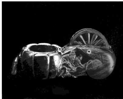
Cordon traceur ( sumitsubo ), XVIII e siècle, fait en un seul morceau de zelvova ( keyaki ).
