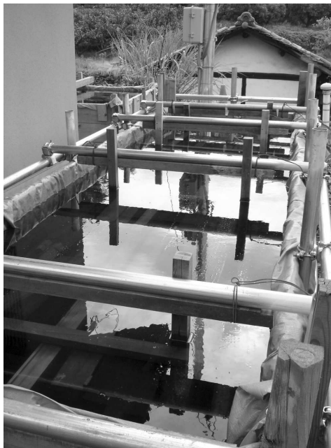
Figure 30 – Piscine où sont plongées les pièces de bois pour les redresser, 2010 (photographie de l'auteur).
