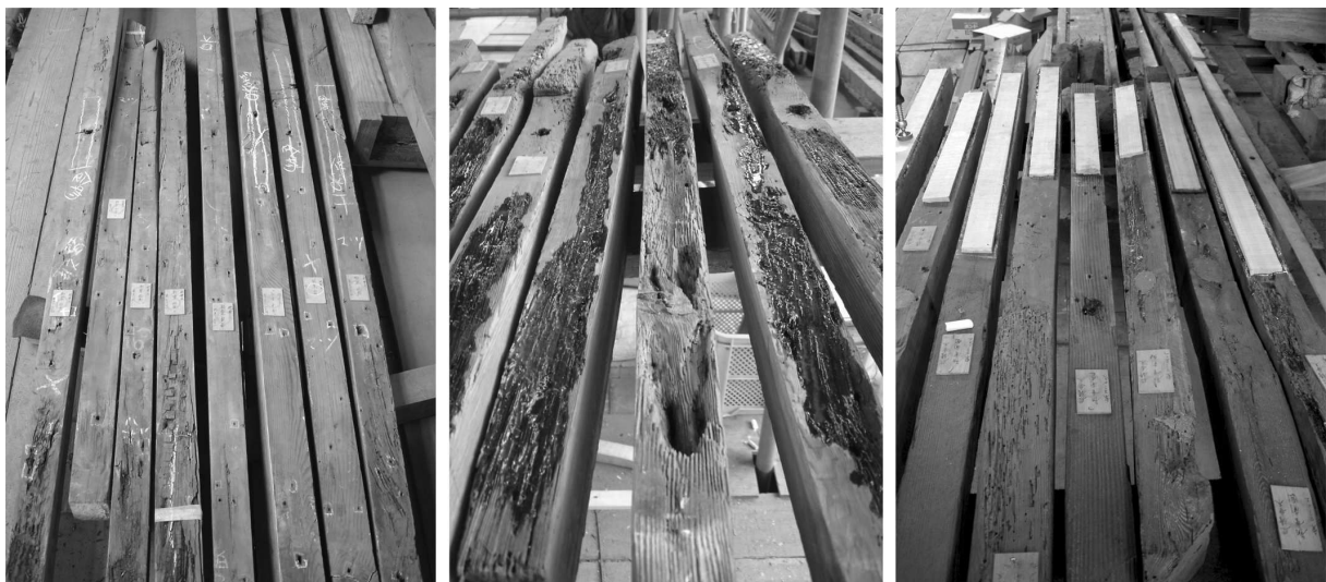
Figure 28 – Trois étapes de réparation de petites pièces : repérage des désordres à la craie, comblement à la résine, ajout de matière, égalisation et ponçage, 2010 (photographies de l'auteur).
