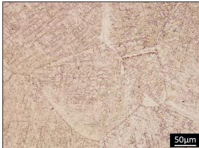
Figure 93 : Microstructure lamellaire observée en microscopie optique pour les essais de frittage SPS de vérification indépendants.
