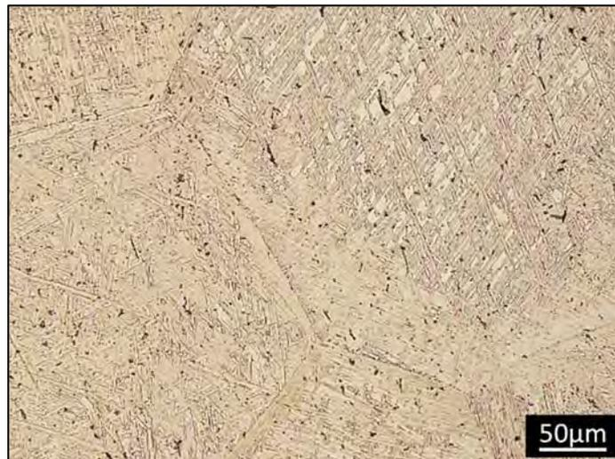
Figure 94 : Microstructure de F1030 observée en microscopie optique.
