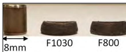
Figure 96 : Morphologie des pions F1030 et F800 après essai de fluage. Un pion de 8mm de diamètre est également sur l'image pour ajuster l'échelle.
