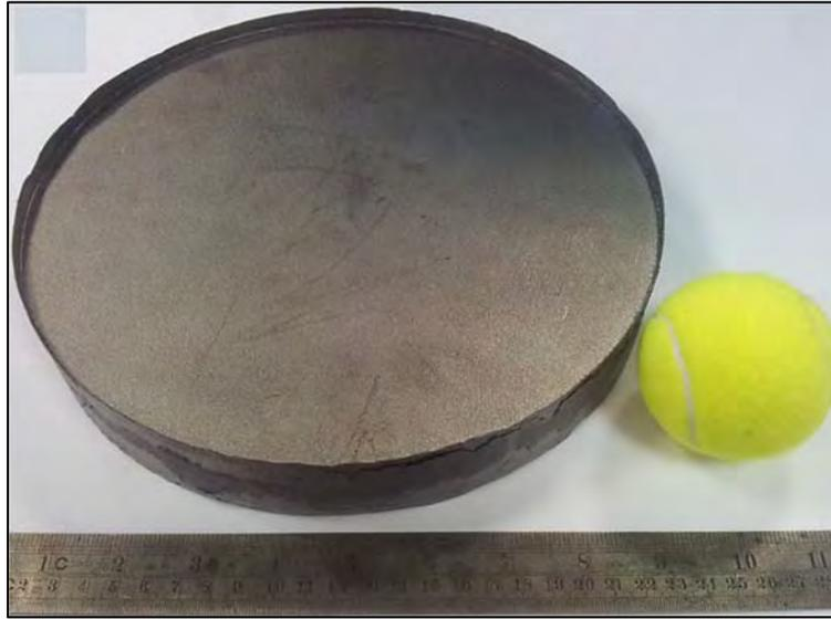
Figure 33 : TA6V fritté par SPS à 1200°C<sup>108</sup>.
