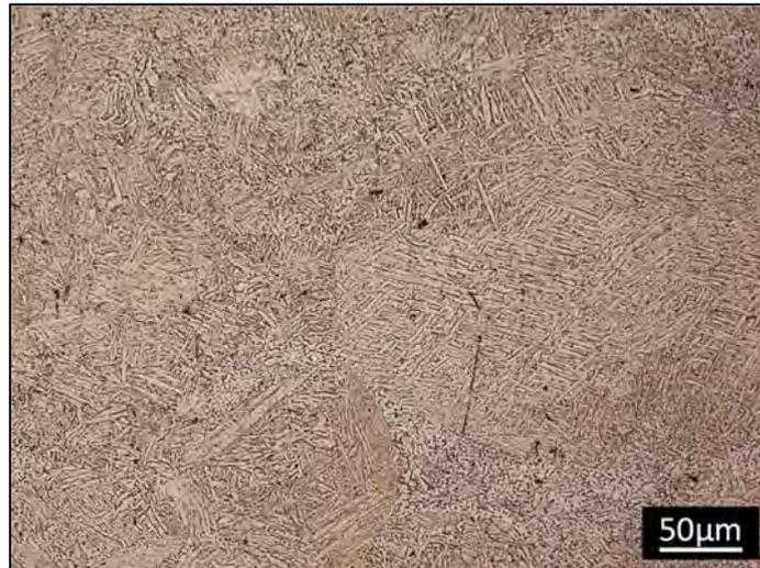
Figure 95 : Microstructure de F800 observée en microscopie optique.
