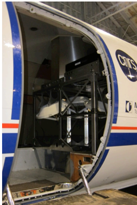
FIGURE 2.17 : Installation du radar RASTA à bord du F20. On distingue dans la carlingue au premier plan les trois antennes orientées vers le bas (avec la permission de Julien Delanoë)
