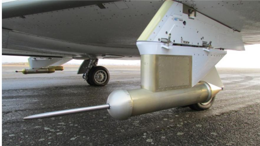
(a) Détail de l'IKP-2 installée sur F20 (extrait de STRAPP et al., 2018)
