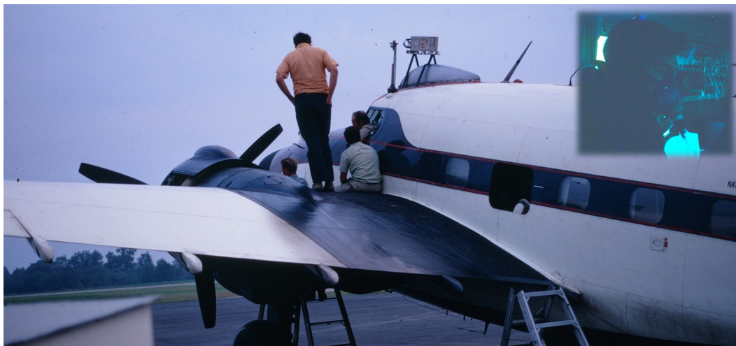
FIGURE 3.2 : Vue de l'ouverture dans la carlingue du DC-3 instrumenté de l'Université de Chicago pour l'échantillonnage des cristaux (avec la permission de A. Heymsfield)
