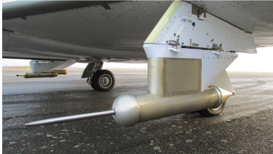
(a) Détail de l'IKP-2 installée sur F20 (extrait de STRAPP et al., 2018)
