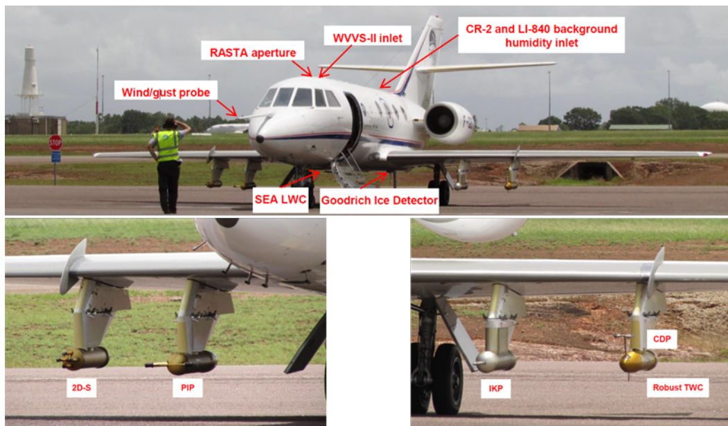
FIGURE 2.4 : Configuration instrumentale du F20. Les abréviations sont définies dans le texte. (extrait de STRAPP et al., 2018, courtesy of Tom Ratoasky, NASA Glenn Research Center)
