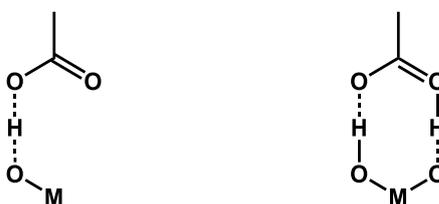
**Figure I.18 Représentation de modes de physisorption par liaison-H des fonctions acide carboxylique sur un oxyde semiconducteur type  $\text{TiO}_2$  (de gauche à droite : liaison monodentate et bidentate)**
