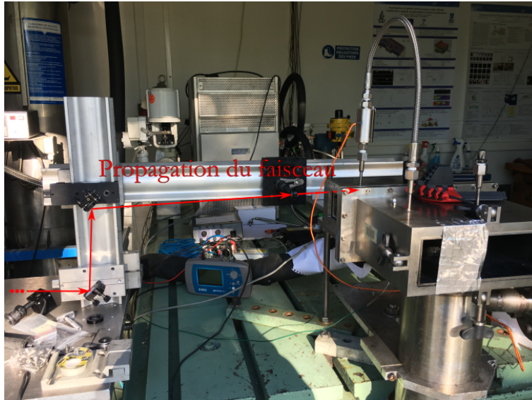
FIGURE 2-55 – Trajet du faisceau dans la chambre trisecteur.
