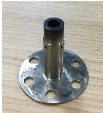
FIGURE 2-54 – Photo du support de bougie du montage trisecteur.
