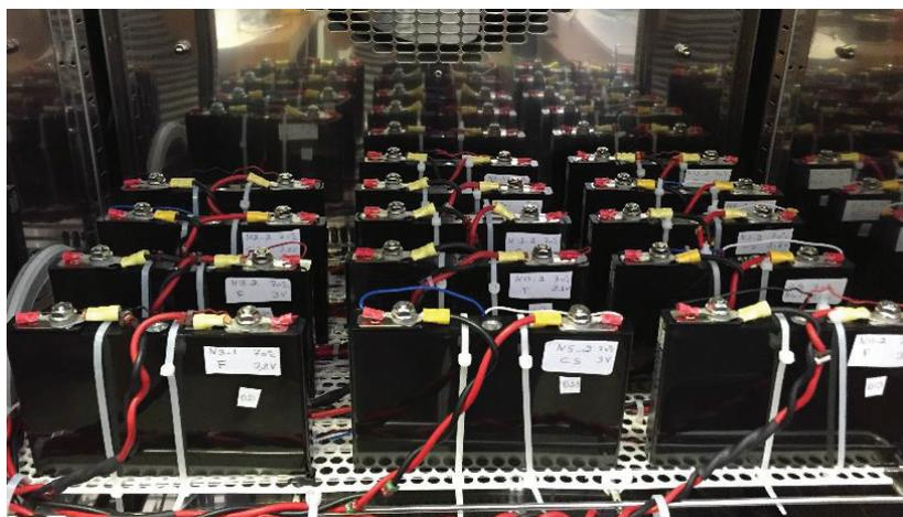
Figure 3.2. LiC installés dans une enceinte climatique.
