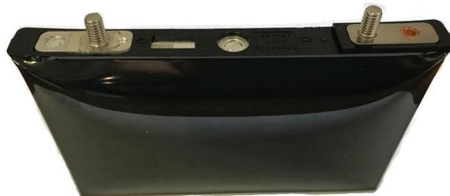
Figure 3.3. LiC gonflé suite à un vieillissement calendaire de 17 mois à 70°C et 3.8 V en mode FC.
