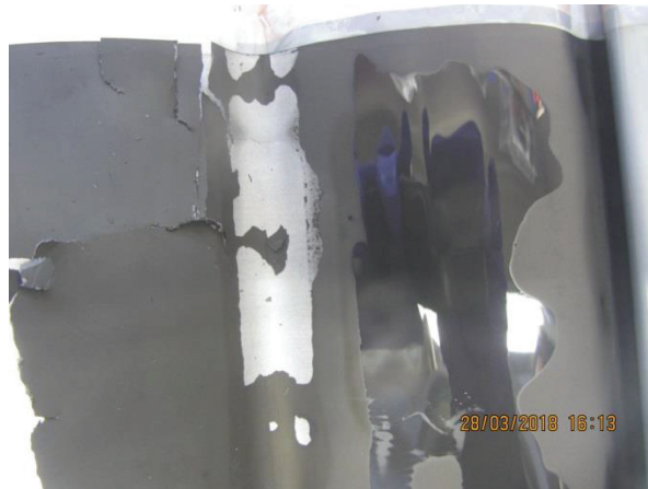
Figure 3.36. Photo de l'électrode positive provenant de la cellule vieillie à 3.8 V et 70°C pendant 17 mois.
