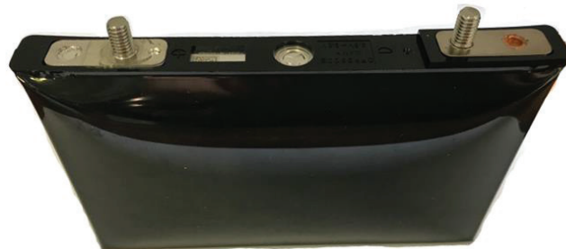
Figure 3.3. LiC gonflé suite à un vieillissement calendaire de 17 mois à 70°C et 3.8 V en mode FC.
