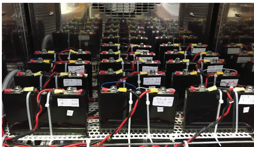
Figure 3.2. LiC installés dans une enceinte climatique.
