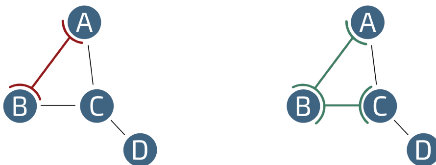
FIGURE 4.3 – Mise en évidence des arrêtes prises en compte lors du calcul de R_{AB} avec la méthode DRG à gauche et avec les méthodes DRGEP et PFA à droite.
