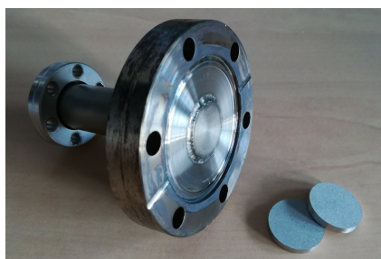
Figure 4.8 – Photographie de filtres métalliques sous forme de pastilles (à droite) et assemblé sur une bride de réduction DN 40-16 CF (à gauche).
