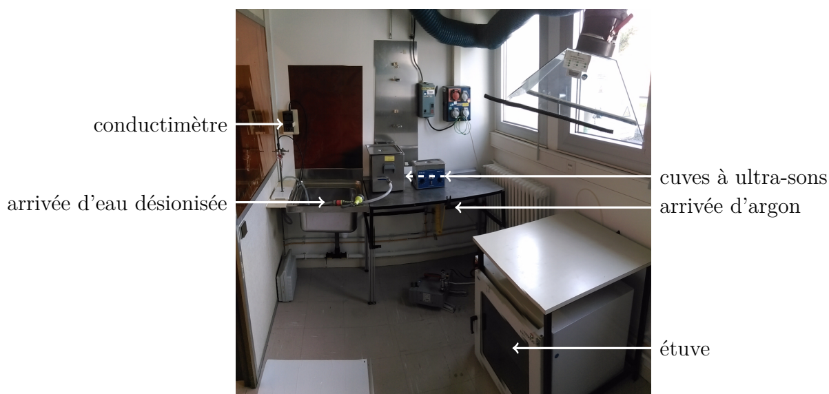
Figure 4.3 – Photographie du matériel permettant le nettoyage compatible ultra-vide des pièces composant le banc de purification et le détecteur.
