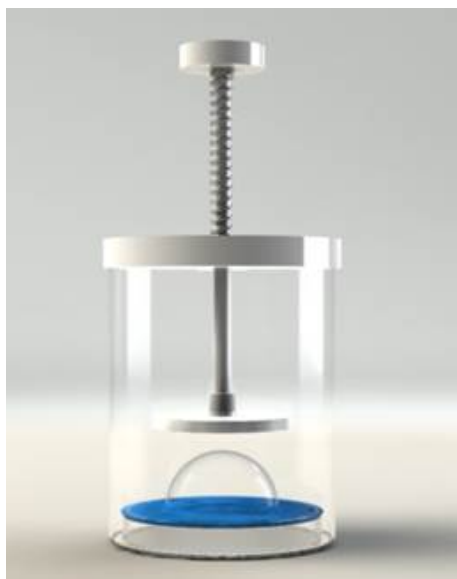
FIGURE 2.4 – Schéma d'un dispositif utilisé pour la méthode de la bulle. La bulle contient des nanotubes de carbone en micelles. Le substrat de silicium est collé sur le support que l'on fait descendre pour faire éclater la bulle.
