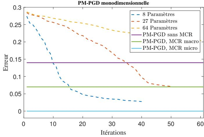
FIGURE 2.10 : Solution monodimensionnelle : comparaison entre la solution issue d'une PGD classique pour différents nombres de paramètres et les erreurs  $\mathcal{E}_{ex}$  issues de plusieurs variantes de la PM-PGD
