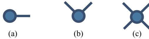
FIGURE 1.3 : Diagrammes tensoriels d'un vecteur (a), d'une matrice (b) et d'un tenseur de dimension 4 (c)
