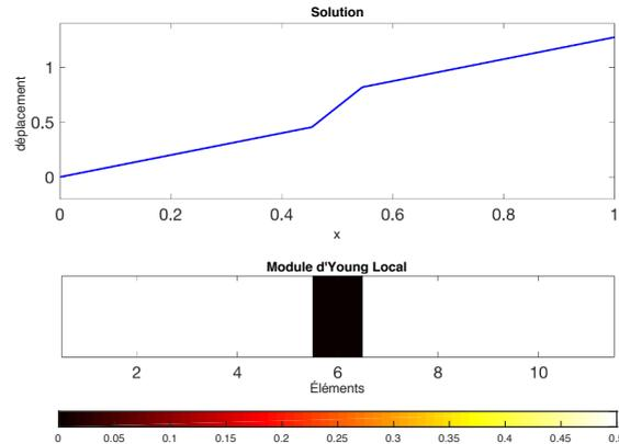
FIGURE 2.9 : Poutre en traction à déplacement imposé : un mouvement de corps rigide affecte tous les éléments situés à droite de l'élément modifié
