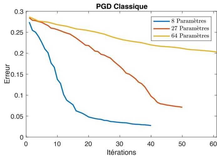
FIGURE 1.12 : Convergence de l’algorithme Progressive Galerkin PGD pour différents nombres de paramètres
