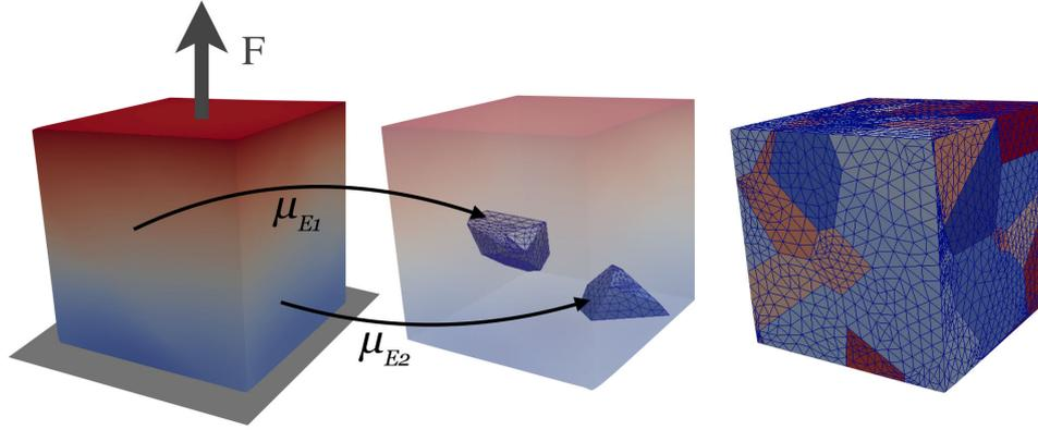
FIGURE 1.1 : Cube encastré en traction : problème modèle; une solution particulière; mise en valeur de deux sous-domaines  $\Omega_{E_1}$  et  $\Omega_{E_2}$ ; maillage et décomposition du cube.
