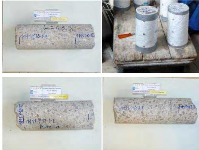
Figure II.6 : Echantillons extraits du barrage de SL pour essais LPC N°44, Guedon - IFSTTAR 2010
