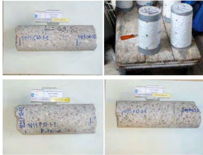
Figure II.6 : Echantillons extraits du barrage de SL pour essais LPC N°44, Guedon - IFSTTAR 2010
