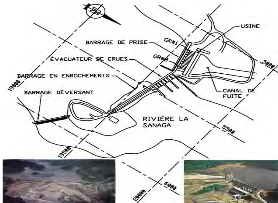
Figure V.5 : Synoptique d'ensemble de l'aménagement hydroélectrique de Song Loulou [ISL 2011]
