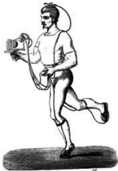
Fig. 156. — Marcheur muni des chaussures exploratrices et portant le chronographe (Marey).
