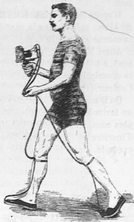
Fig. 156. — Marcheur muni des chaussures exploratrices et portant le chronographe (Marey).
