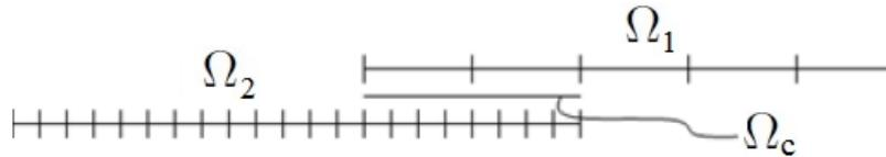
FIGURE 2.7 – Modèle discret de la barre Arlequin 1D
