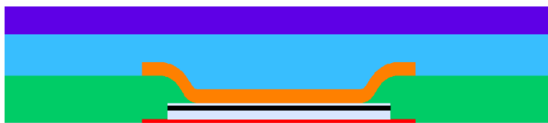
FIGURE 3.10 – Vue en coupe de la technologie RLC06A dont les paramètres variables sont : Capa2 (noir), Meta2 (orange), BCB1 (vert) et Metal1 (rouge).
