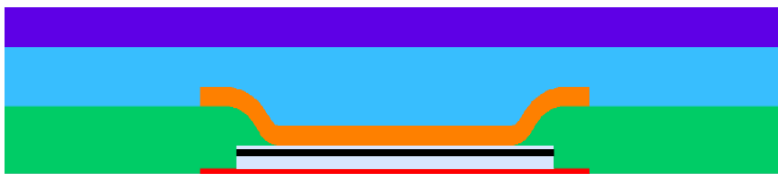
FIGURE 3.10 – Vue en coupe de la technologie RLC06A dont les paramètres variables sont : Capa2 (noir), Meta2 (orange), BCB1 (vert) et Meta1 (rouge).
