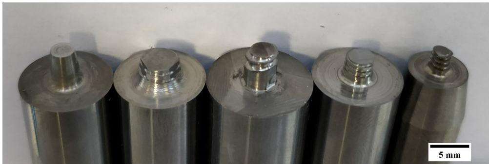
Figure 1.3 – Exemple de géométries de pion. De gauche à droite : sans filetage, court large avec filetage et méplats, avec filetage large, filetage simple et trois méplats, avec filetage profond. L'épaulement est toujours plat et lisse.
