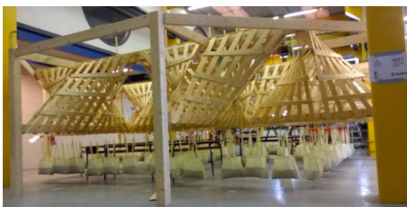
FIGURE 2.7 – (a) Photographie de la structure en bois chargée uniformément à l'aide de sacs de sable. (b) Déplacements verticaux évalués par TRACKER (points rouges et bleus); les valeurs effectuées au comparateur (symboles carrés rouges et bleus) avec leurs barres d'erreur estimées sont également indiquées; les autres courbes sont issues de différentes modélisations de type RDM (non détaillées ici).
