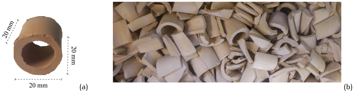
FIGURE 2.2 – Coque en agile cuite développée par l'Andra : (a) dimensions d'une coque intacte, (b) des coques cassées (et quelques coques intactes) suite à une compression œdométrique à 420 kPa
