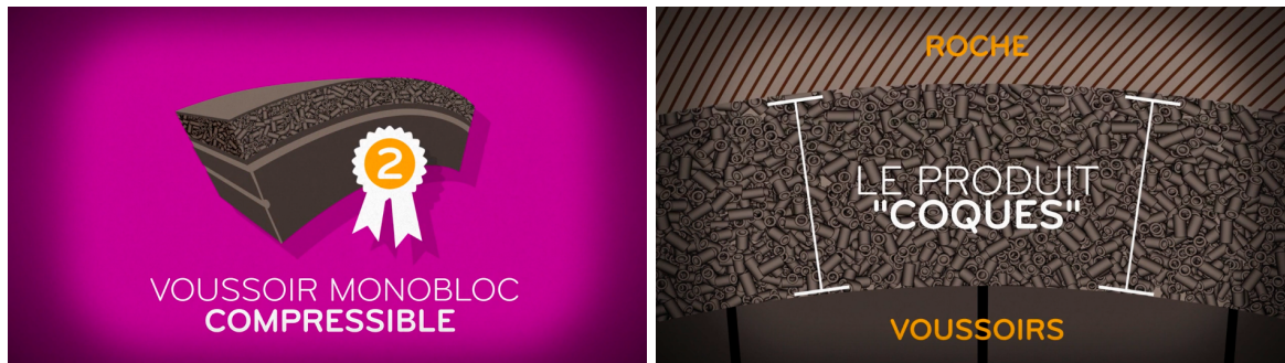
FIGURE 2.1 – Voussoir monobloc compressible breveté par l'Andra (2016). Images tirées d'une vidéo (Guillaume DAUPEYROUX, DGPRESS, https://vimeo.com/200807244 )
