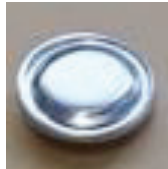
Fig.II.A-4 : Photographie d'une capsule DSC Perkin Elmer . Ref : 0219-0062.
