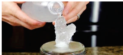
Fig.I.A-1 : Illustration du phénomène de surfusion. De la glace peut se former sur un cristal de glace déjà formé, mais elle ne se forme pas dans le récipient qui contient de l'eau liquide en surfusion.
