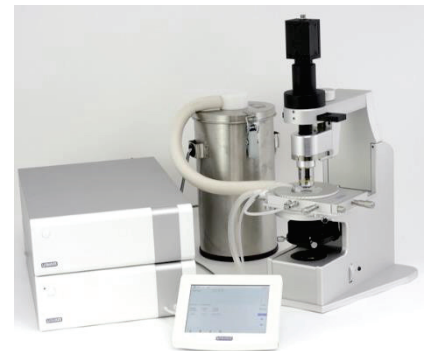
Fig.II.F-1 : Photographie de la platine BCS196 (Linkam Instrument) installée sur un microscope optique.
