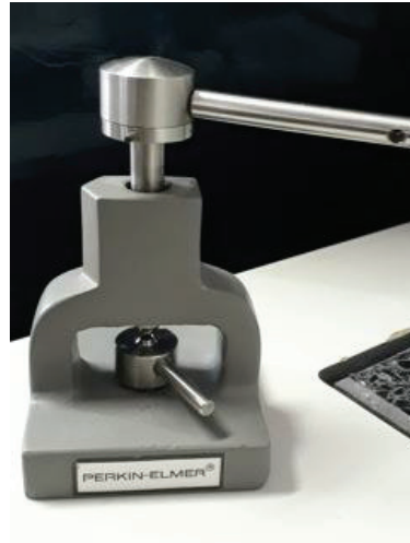
Fig.II.A-5 : Photographie de la presse Perkin Elmer permettant de celer les capsules DSC. Ref : 0219-0062.
