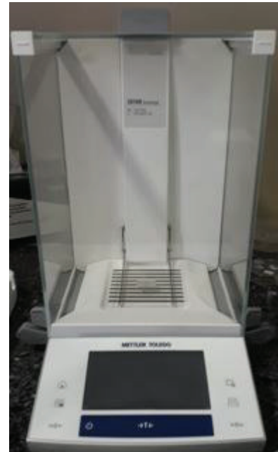
Fig.II.A-6 : Photographie de la balance de pesée ultra-sensible XS105 DualRange de chez Metler Toledo . Résolution = 10 -5 g.
