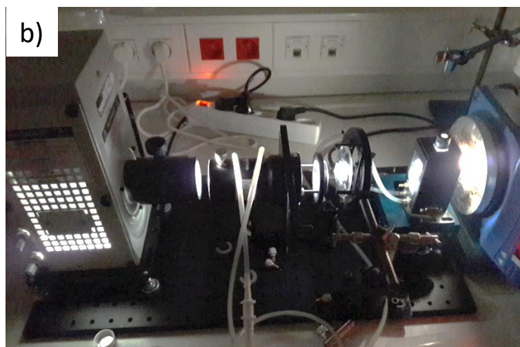
Figure 91 : Schéma optique utilisé (a) et photographie du banc lors de son utilisation en photocatalyse (b).
