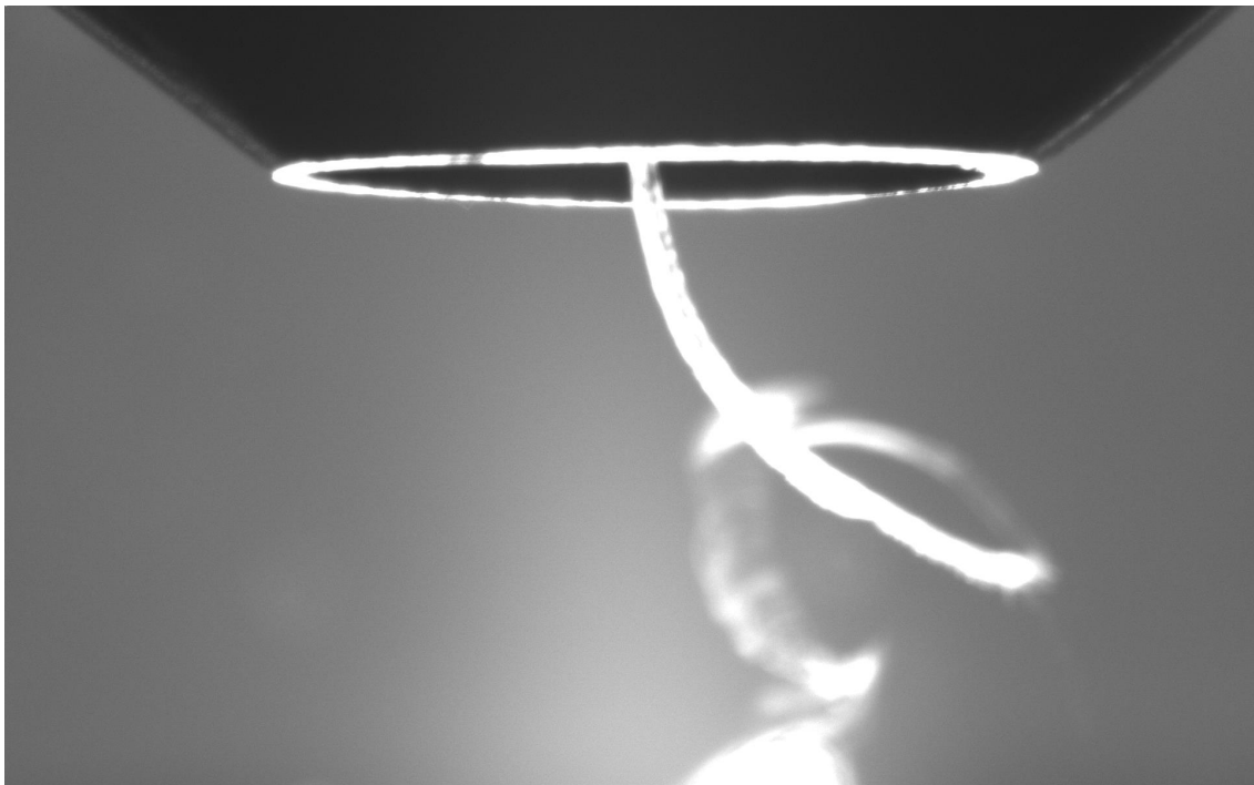
FIGURE 2.12: Photo d'un ruban commençant à former une boucle.
