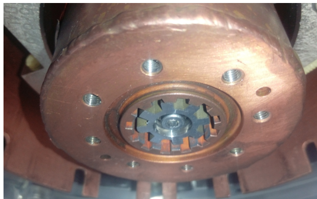
FIGURE 3.12: Vue du dessous du cisso et de l'échangeur de chaleur ; les ailettes et les cannelures sont bien visibles.
