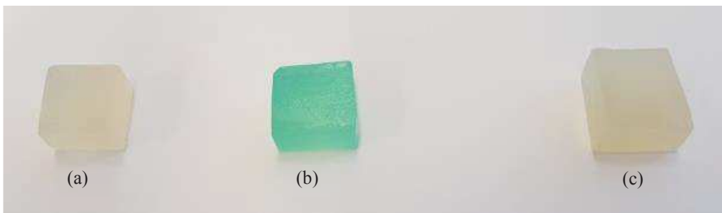
Figure IV.2 Hydrogels en volume : (a) alginate de calcium, (b) alginate de cuivre et (c) alginate de zinc
