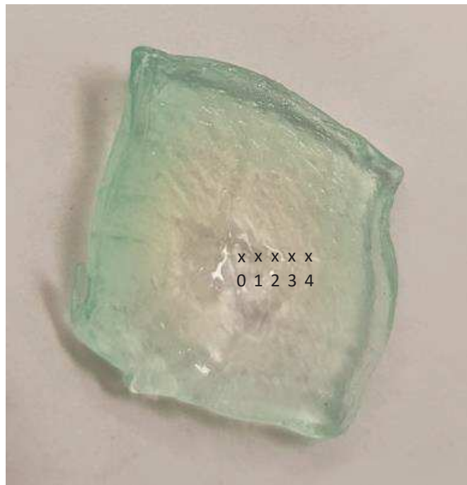
Figure IV.5 Photo montrant le gradient de cuivre à l'œil nue dans une tranche centrale de l'hydrogel Ca_{0,27}Cu_{0,05} avant séchage et les différentes positions où l'EDX a été effectué
