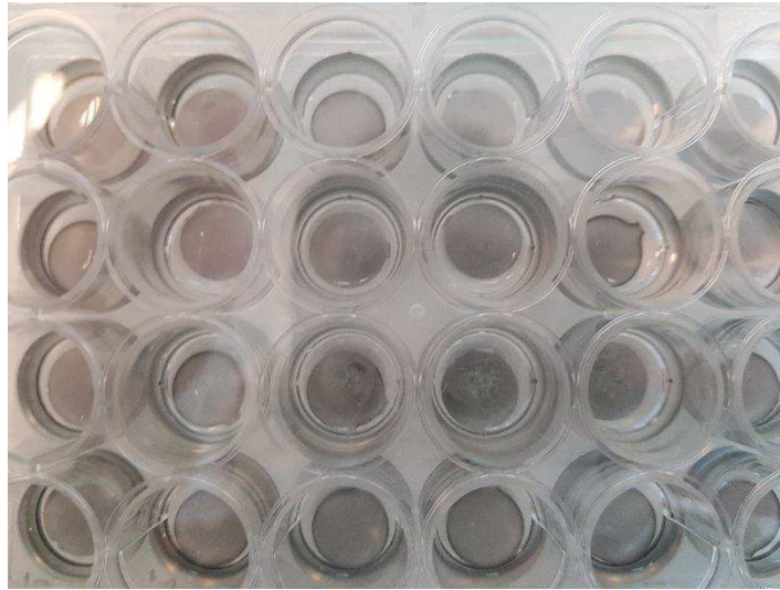
Figure II.7 Plaque de 24 puits en présence des films déposés sur acier pour une souche de microalgues après une semaine d'incubation
