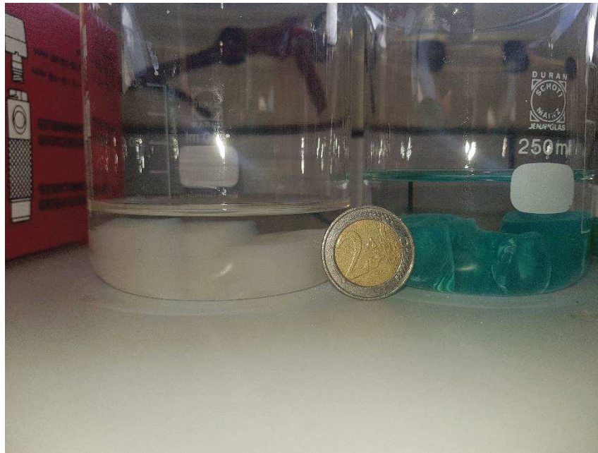
Figure IV.26 Cubes d'hydrogel Zn_{0,1} et Cu_{0,1} utilisés lors de la première expérience
