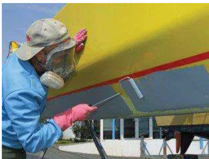
Figure I.11 Application de peinture antifouling sur la coque d'un bateau
