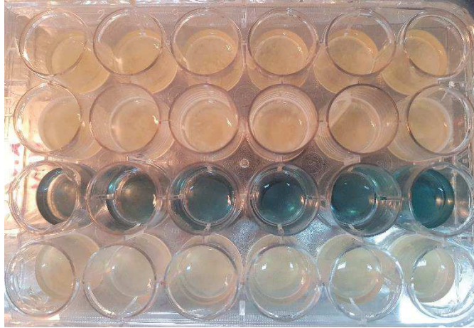
Figure II.8 Plaque de 24 puits en présence des matériaux à tester pour une souche de bactéries marines après 24h d'incubation
