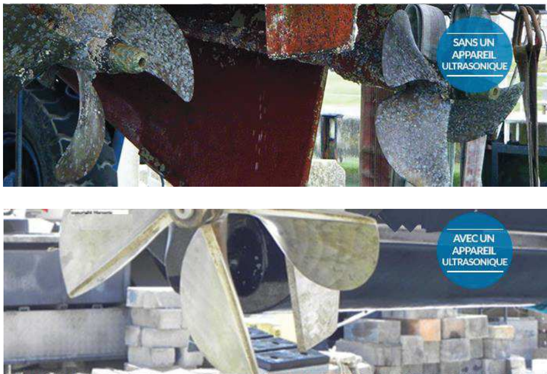
Figure 1.8 Effet de l'application d'ultrasons par l'appareil Gom'air sur le système de propulsion d'un bateau [71]
