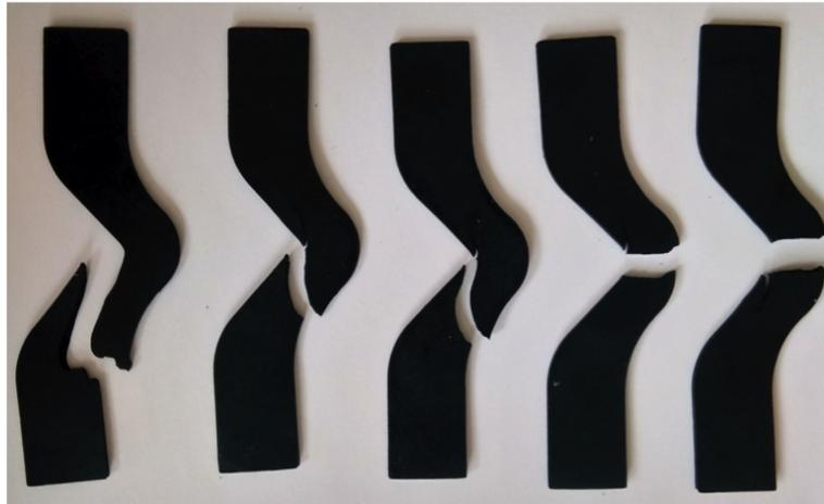
**Figure 5.6** – Fissures déchirement angulaire du mélange rCB Vapo\_rCB\_N330
