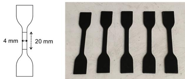
**Figure 2.18** – Forme des éprouvettes haltères
