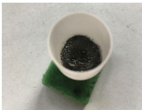
**Figure 3.32** – Carbone résiduel obtenu après un cycle de pyrolyse appliqué au SBR
