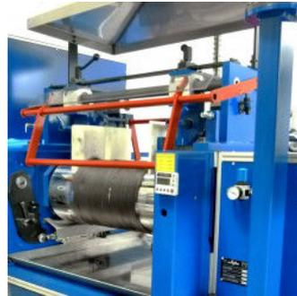
**Figure 2.16** – Mélangeur à cylindres Agila ( $150 \times 350$ ) du LRCCP
