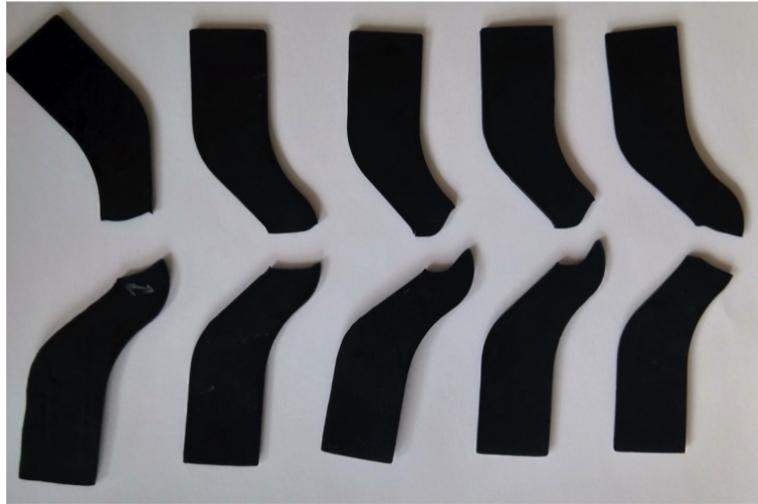
**Figure 5.5** – Fissures déchirement angulaire du mélange témoin N330
