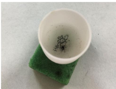
**Figure 3.31** – Carbone résiduel obtenu après un cycle de pyrolyse appliqué au NR
