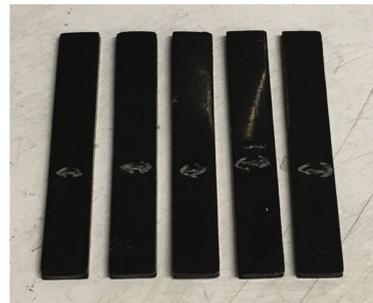
**Figure 2.20** – Forme des éprouvettes pour le déchirement Delft
