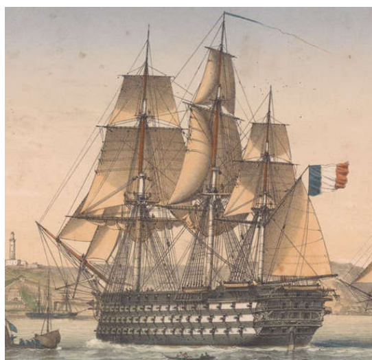
Le Vaisseau Friedland (ex Inflexible), armé de 118 canons, déplacement 5100 tonnes, commencé en 1812 et lancé en 1840
