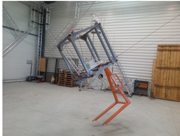
Figure 2.6: Le RPC CoGiRo à 8 câbles et 6 DDL
