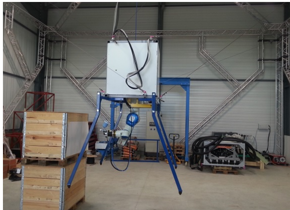
Figure 1.1: Le RPC CoGiRo équipé d'un bras série SIA20F de Yaskawa
