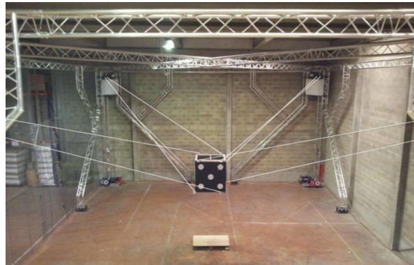
Figure 1.2: Le RPC CoGiRo à 8 câbles et 6 DDL
