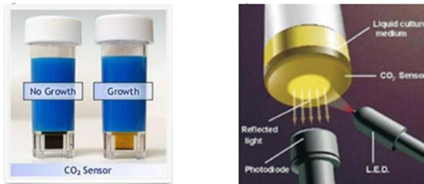
Figure 1.3-3. Flacons utilisés pour la détection du CO<sub>2</sub> avec le système BioLumix (à gauche) et BacT/Alert 3D (à droite). Sources : [www.mybiolumix.com](http://www.mybiolumix.com) et [www.biomerieux.fr/diagnostic-clinique/bactalertr-3d-systeme-de-detection-microbienne](http://www.biomerieux.fr/diagnostic-clinique/bactalertr-3d-systeme-de-detection-microbienne).
