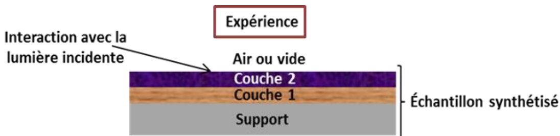
Figure II. 12 : Schématisation du modèle sur lequel est basée l'analyse ellipsométrique des couches minces sur support réfléchissant.
