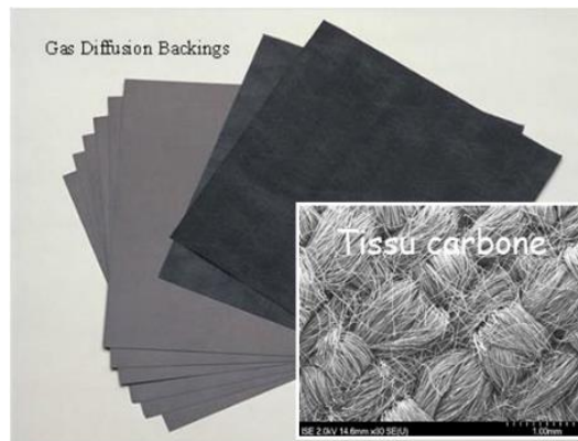
Figure II. 5 : Tissu en carbone poreux conducteur E-Tek®.
