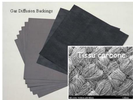
Figure II. 5 : Tissu en carbone poreux conducteur E-Tek®.
