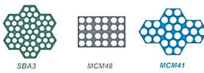
Figure I. 2: Différentes structures de silice synthétisées par voie sol-gel préparées avec le même tensioactif et le même précurseur de silice.
