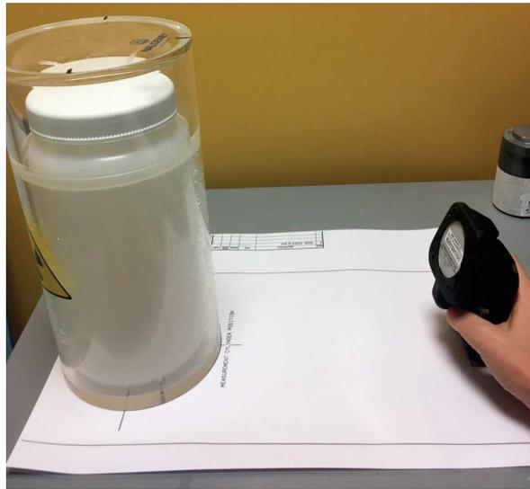
FIGURE 1.10 – Mesure du débit de dose des déchets (flacon + matériel radiologique utilisé).
