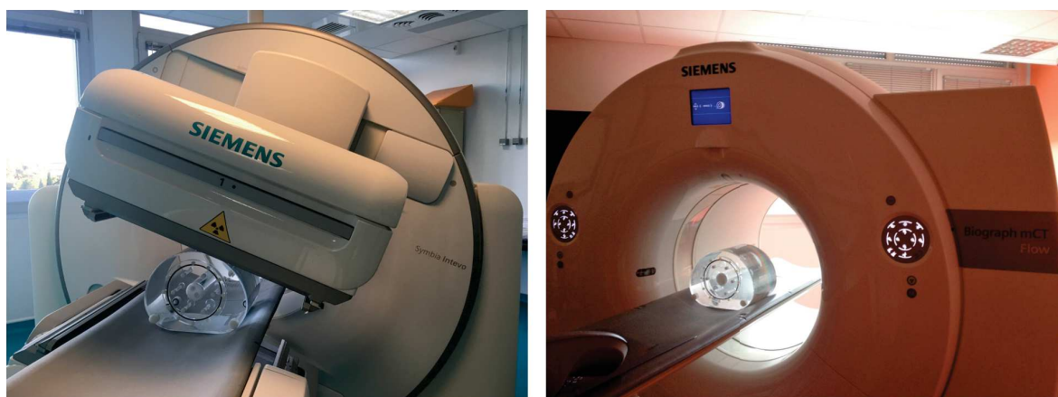
FIGURE 3.3 – Acquisition d'images TEMP (à gauche) et TEP (à droite) du fantôme NEMA.
