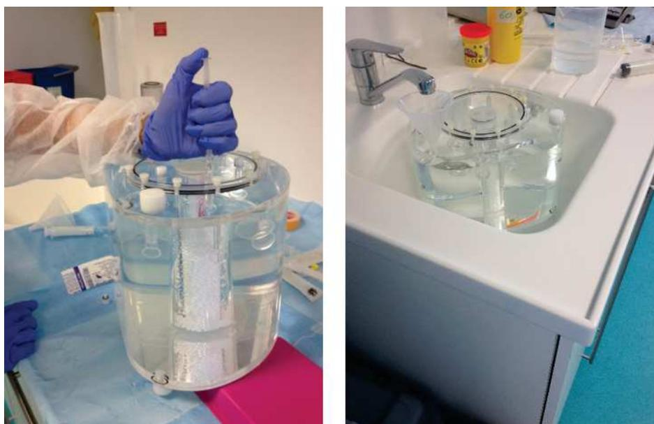
FIGURE 2.6 – Illustration de la détermination du facteur de calibration sur la gamma caméra. Remplissage des six sphères avec la même concentration d'activité de technétium-99m de 144 kBq/mL (à gauche) et du fond avec de l'eau seulement pour l'acquisition avec un rapport de concentration sphères/fond infini (à droite).
