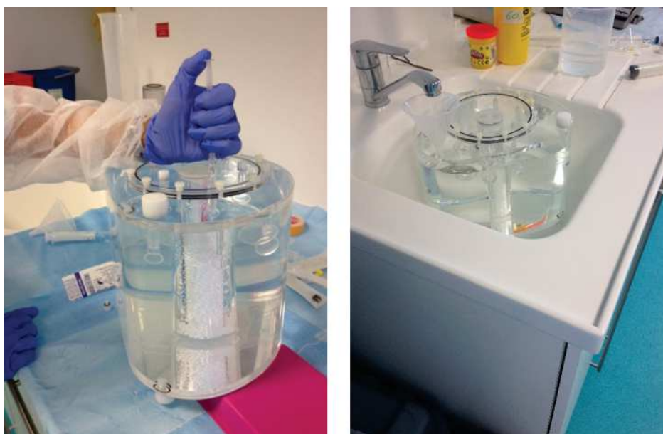
FIGURE 2.6 – Illustration de la détermination du facteur de calibration sur la gamma caméra. Remplissage des six sphères avec la même concentration d'activité de technétium-99m de 144 kBq/mL (à gauche) et du fond avec de l'eau seulement pour l'acquisition avec un rapport de concentration sphères/fond infini (à droite).
