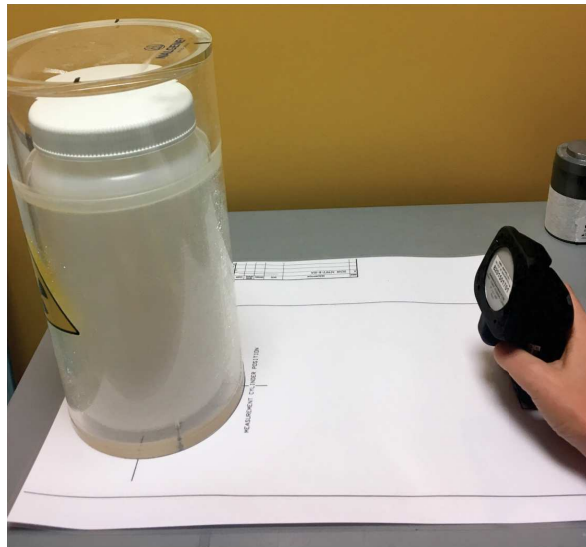
FIGURE 1.10 – Mesure du débit de dose des déchets (flacon + matériel radiologique utilisé).
