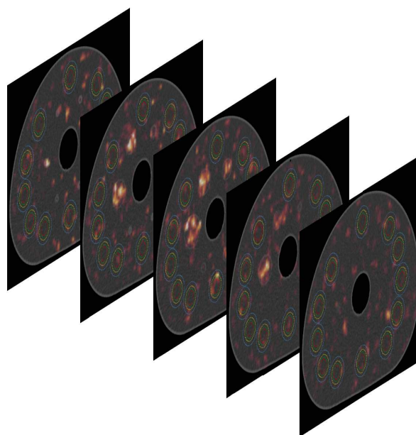
FIGURE 3.6 – Illustration du positionnement des ROI dans le fond du fantôme. 12 ROI de diamètre correspondant à celui de la sphère 6 (en bleu), de la sphère 5 (en jaune), de la sphère 4 (en vert) et de la sphère 3 (en rouge) sur cinq coupes différentes à plus ou moins 1 cm et 2 cm de la coupe centrale, soit un total de 60 ROI de taille identique.
