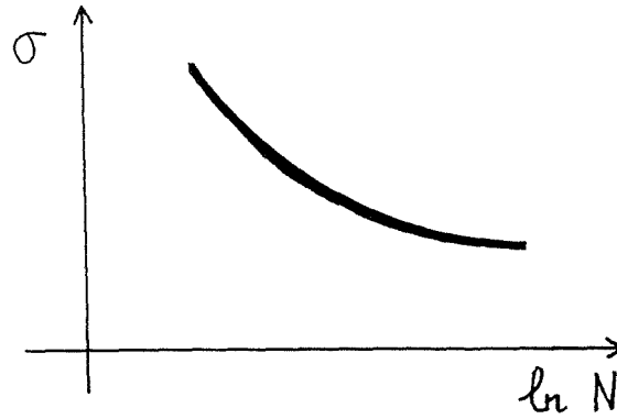
figure 2.14: Allure du comportement sous sollicitations répétées (HERTZBERG 1988).
