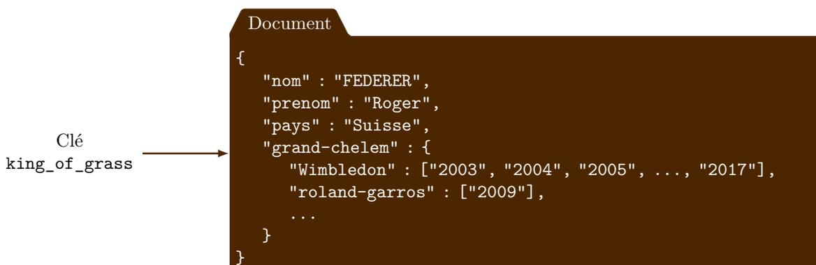
FIGURE 4.7 – Illustration du modèle de représentation des SGBDs NoSQLs orientés document.
